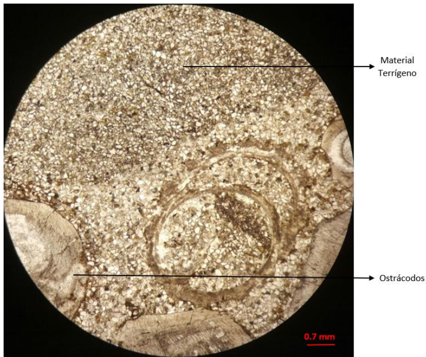
Figura 158: Se observan ostrácodos y material terrígeno en luz polarizada plana con objetivo 4X.
